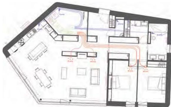
**Fig. 8.2 Le positionnement de la VMC double flux**
